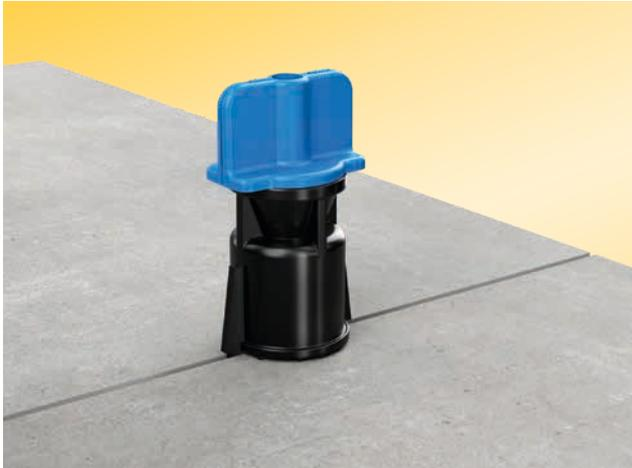
Das IndorTec® FN Nivelliersystem richtet Fliesen und Platten, auch Großformate, akkurat zueinander aus. Unebenheiten durch Überzähne gehören der Vergangenheit an. Die Anwendung ist ausgesprochen einfach in nur 3 Handgriffen: Aufstecken, Arretieren, durch Drehung fixieren. IndorTec® FN verankert sich in der offenen Fuge, dadurch verursacht es keinerlei Kratzer oder Abdrücke auf der Belagsoberfläche.
