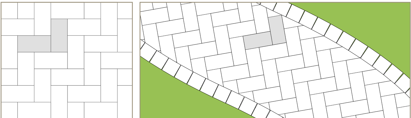
225x454 = 100% Fertigung eines Wegs mit L-förmigem Element.
