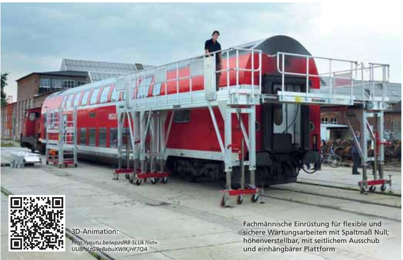
Fachmännische Einrüstung für flexible und sichere Wartungsarbeiten mit Spaltmaß Null; höhenverstellbar, mit seitlichem Ausschub und einhängbarer Plattform
