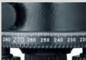
Horizontalkreis mit endlosem Seitenfeintrieb zum präzisen Anvisieren.
