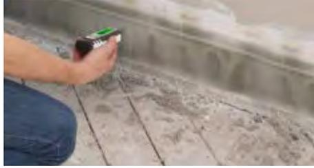
**Profi-Messgerät zur Messung von Holz-, Putz-, Bau- und Materialfeuchte mit Digital Connection-Schnittstelle**
