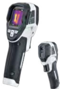
**Wärmebildkamera zur Visualisierung von Temperaturverläufen für den Einsatz im Bauwesen, Elektrotechnik und Industrie**
